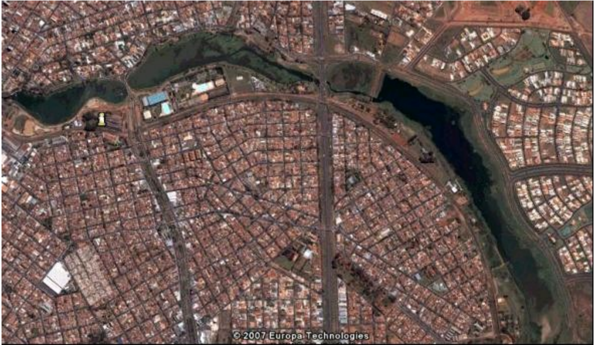
Represa de São José do Rio Preto, onde a água das chuvas chega pelas principais avenidas e onde ocorre a contaminação por esgoto doméstico e agroindustrial nos rios abastecedores (Foto: Googlemaps, 2006)
