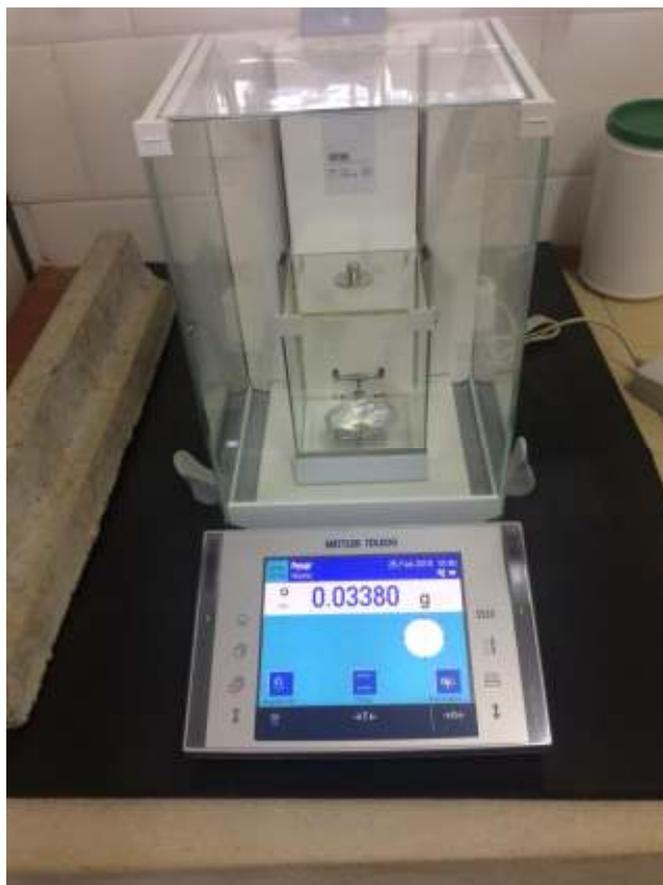
FIGURA 11 – Balança de precisão Mettler.
