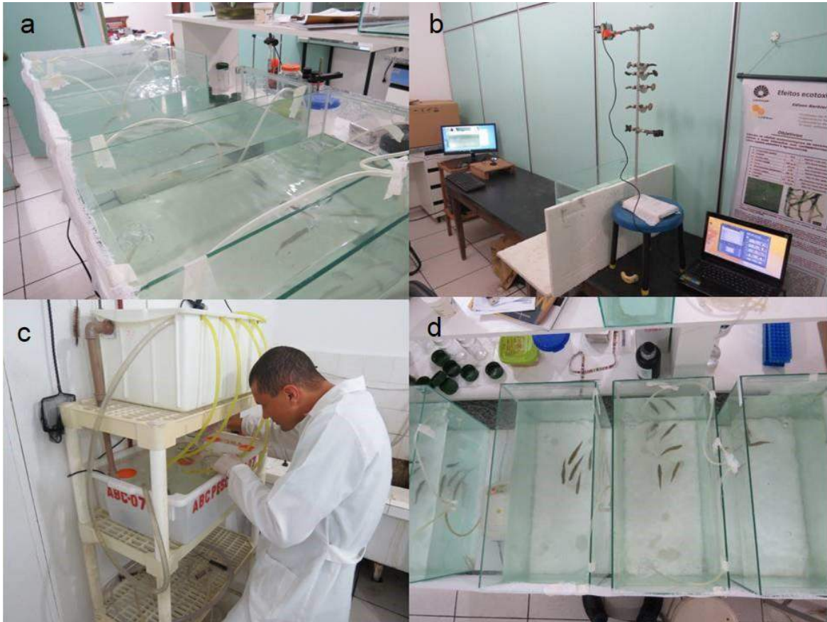
Processos de exposição ao poluente e análises: a) Grupos de Exposição; b) sistema de filmagens; c) respirômetros; e d) aquários para exposição.
