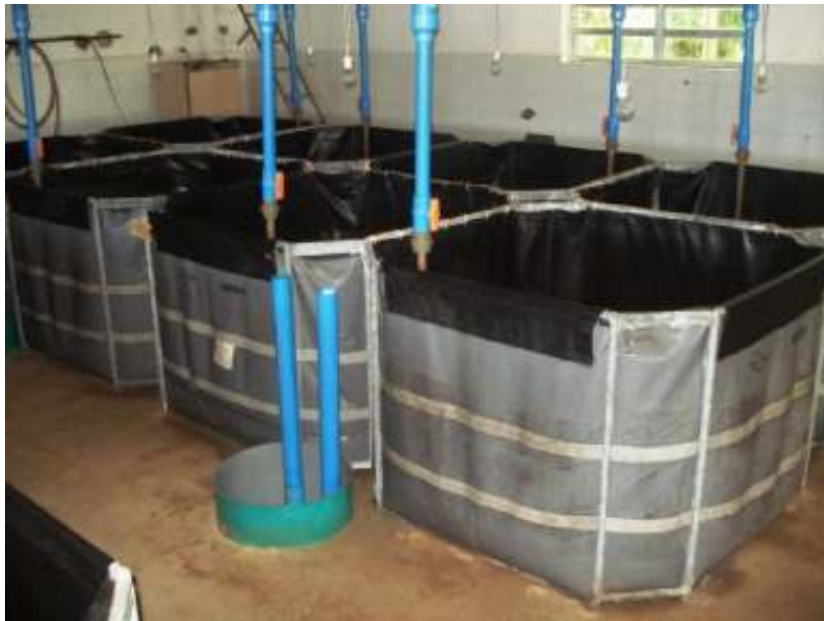
Figura 2. Tanques de lona utilizados em sistema de recirculação. Fonte: Instituto de Pesca
