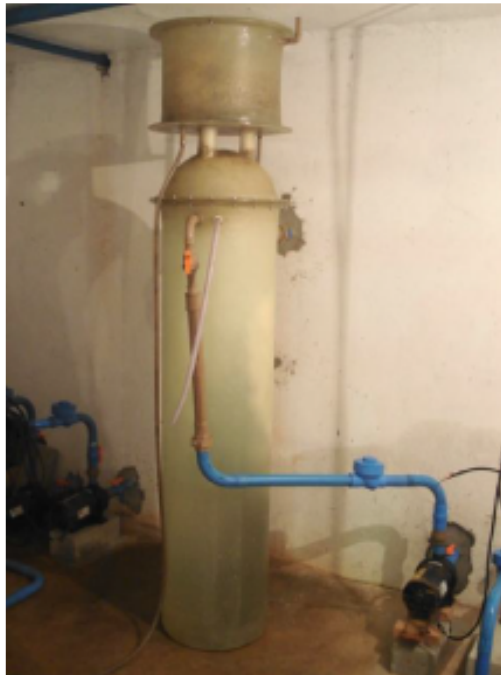
Figura 5. Skimmer em sistema de recirculação de 32.000 litros para criação de peixes marinhos. Fonte: Instituto de Pesca
