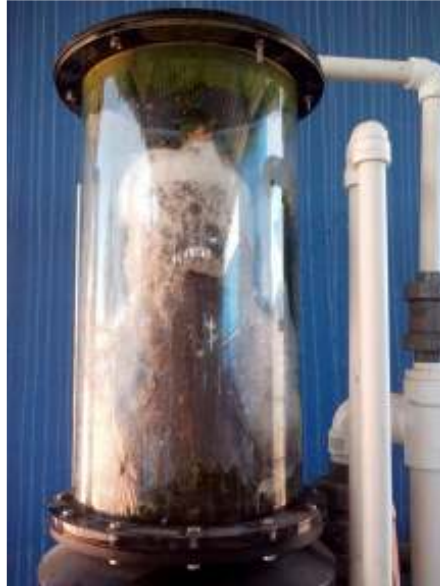
Figura 6. Espuma sendo descartada em skimmer . Fonte: Aquário de Ubatuba
