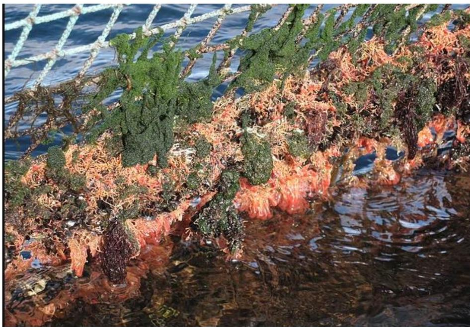
Figura 4 – Panagem de nylon multifilamento com bioincrustação.
