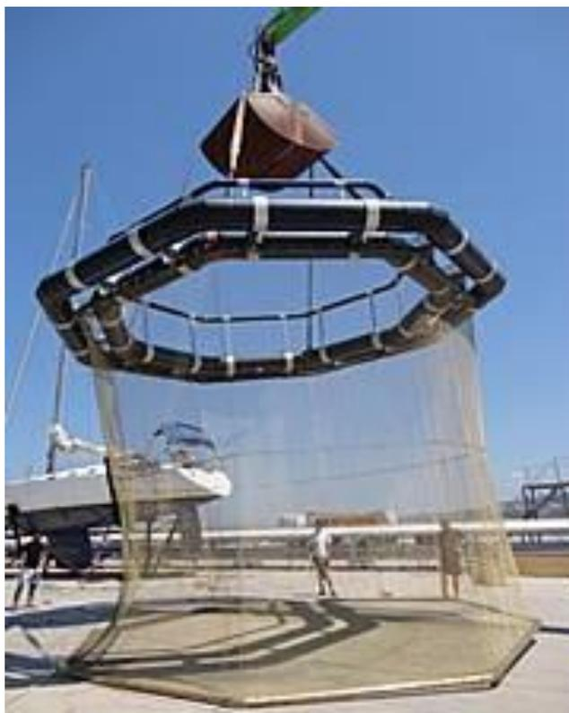
Figura 6 – Tanque-rede com malha de cobre.
