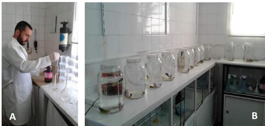
**FIGURA 1:** A-Preparação da solução padrão. B- Testes preliminares, para obtenção da (CL<sub>50-96h</sub>). Laboratório do Polo APTA - Vale do Paraíba.
