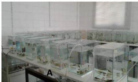
**FIGURA 2:** A-Testes agudos, para obtenção da (CL<sub>50-96h</sub>) do formaldeído em sala aclimatiza. Laboratório do Polo APTA - Vale do Paraíba.
