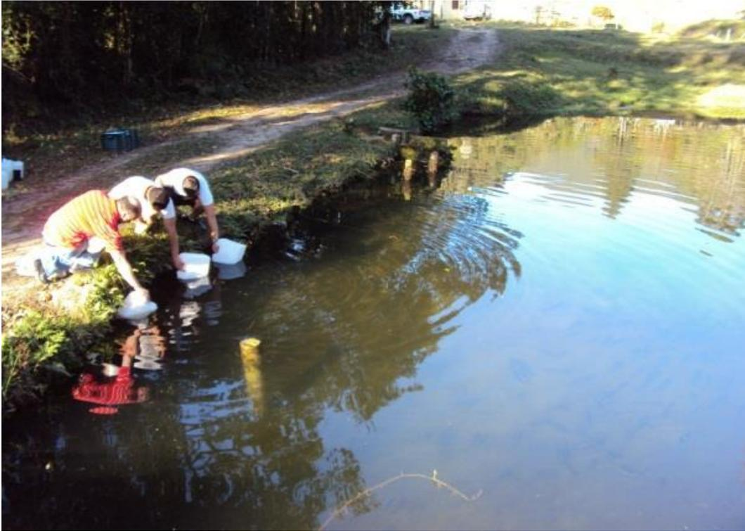
Figura 7- Foto com visão parcial do P4 - efluente do sistema de produção, após a passagem por uma lagoa de estabilização.
