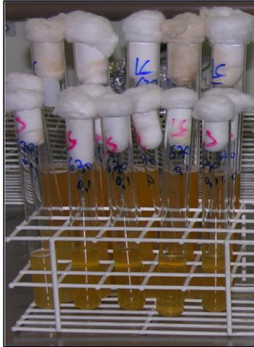
Figura 8 - Tubos inoculados com 1 ml e 0,1 ml de água contendo Caldo Lauryl Sulfato de Sódio, em concentração simples.
