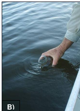
Figuras 3a e 3b - Vidro neutro de borossilicato previamente autoclavado e coleta de água superficial.
