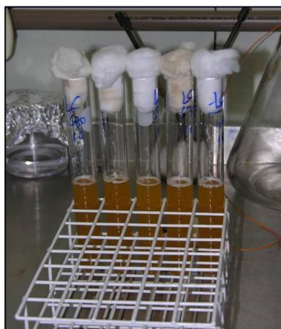
Figura 7 - Tubos inoculados com 10 ml de água contendo Caldo Lauril Sulfato de Sódio, em concentração dupla.
