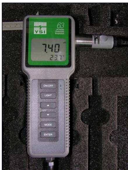
Figura 15 - Equipamento de medição multiparâmetro YSI-63.
