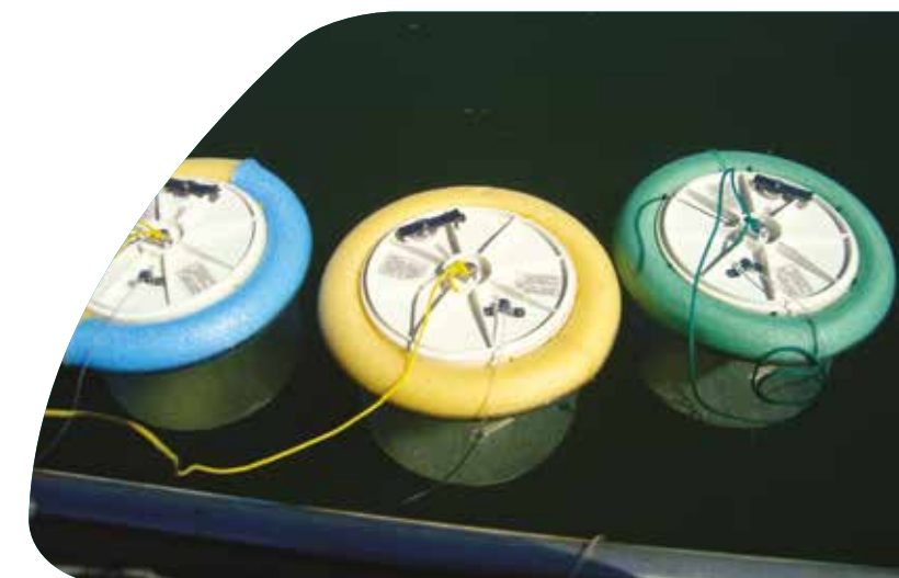
Foto 2. Câmaras estáticas para coleta e determinação de fluxo de GEE. Crédito: Marcelo Gomes da Silva.
