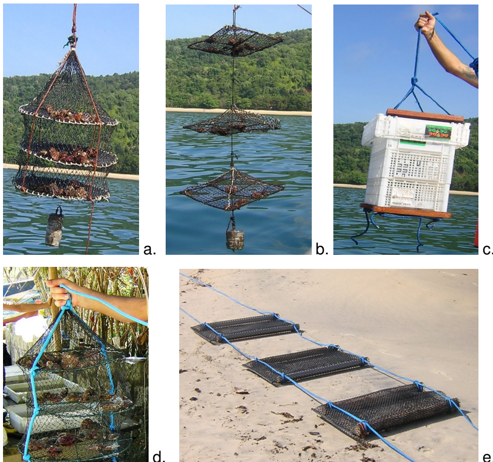
FIGURA 3 - Fotos das estruturas de cultivo utilizadas no presente trabalho: lanterna japonesa (a), pearl-net (b), bo-net (c), lanter-net (d) e travesseiros (e).
