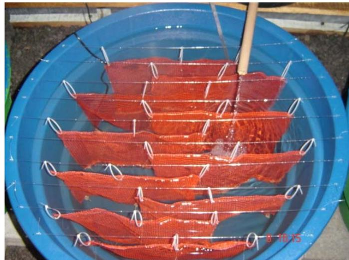
Figura 3 – Disposição das telas de nylon “surfaces” dentro dos tanques experimentais
