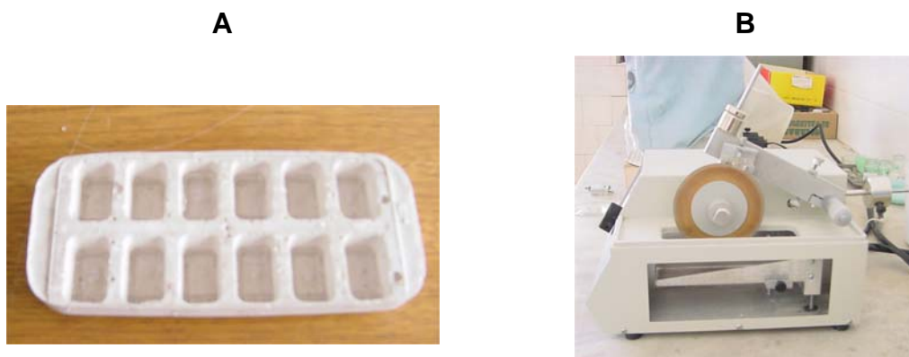
Figura 4. A- Forma de silicone para emblocagem dos espinhos e B- cortadeira metalográfica de baixa rotação.
