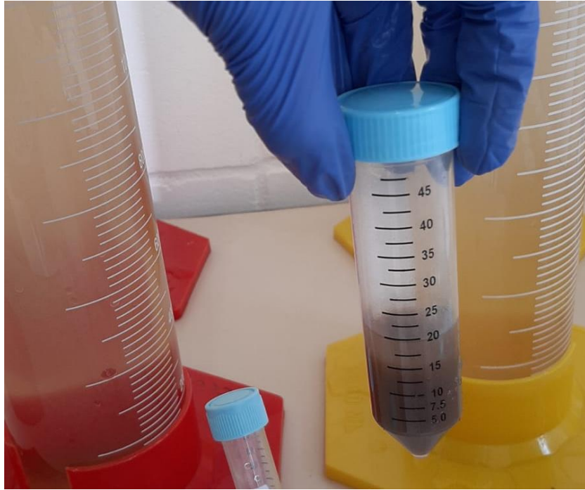
Anexo 3. Amostra de biofloc coletada para liofilização e posterior análise de proteínas totais e Microscopia eletrônica de varredura e transmissão.
