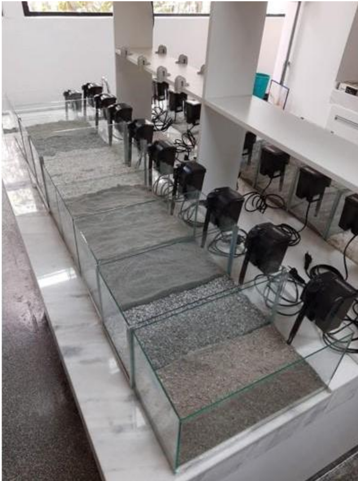
Anexo 4. Disposição dos aquários durante a segunda e a terceira experimentação, demonstrando as diferenças entre os tratamentos constituídos de rocha gnaisse de diferente granulometria.
