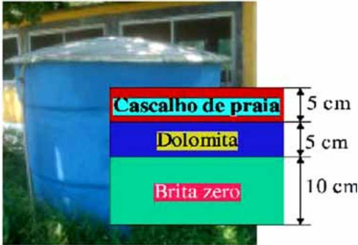
Figura 2. Posicionamento dos elementos filtrantes do sistema do filtro biológico.
