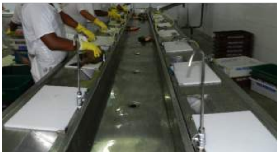
Figura 10. Modelo de mesa de evisceração adotado após a intervenção.
