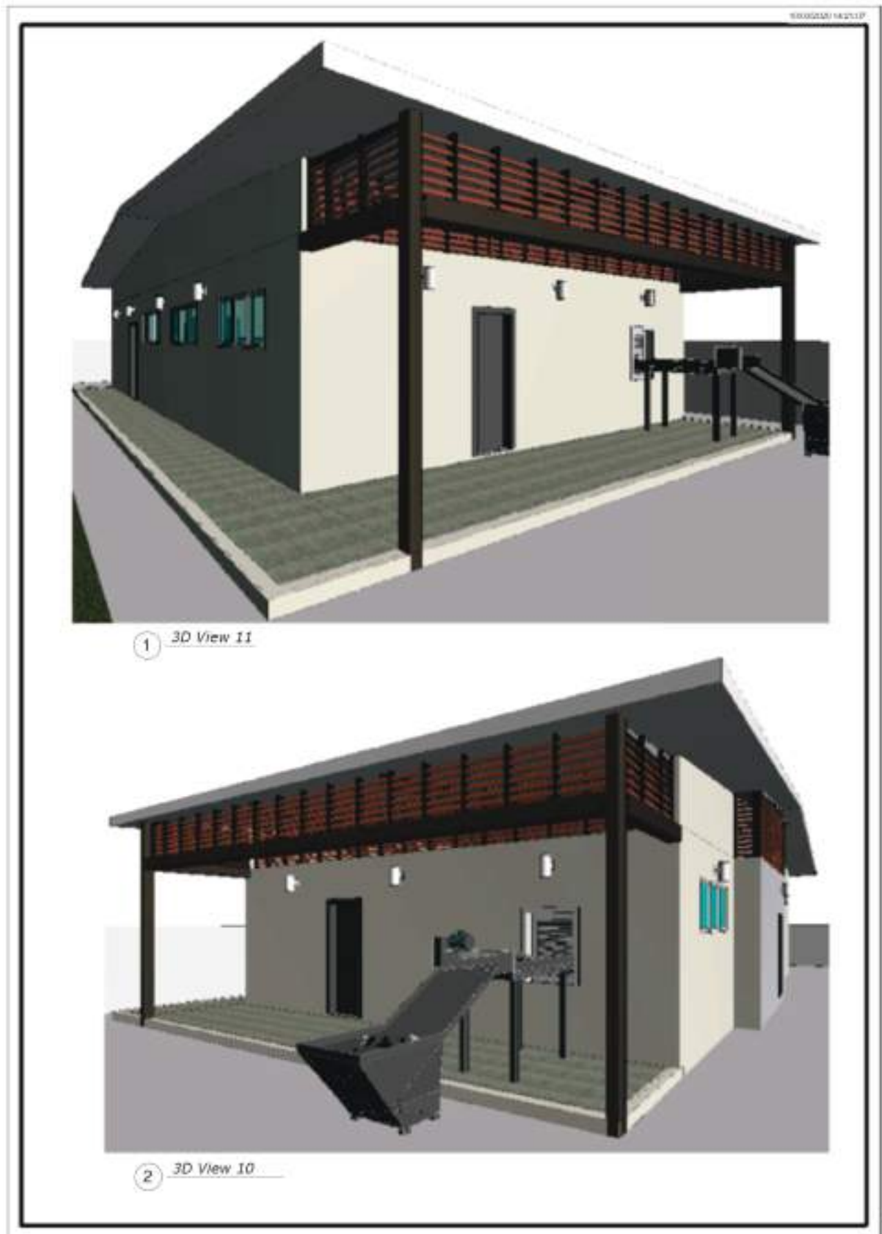
Figura 3. Exemplo de projeto para uma unidade de beneficiamento de pescado (UBP). Imagens em 3D das fachadas laterais demonstrando janelas, cobertura para a recepção do pescado e entrada na indústria.
