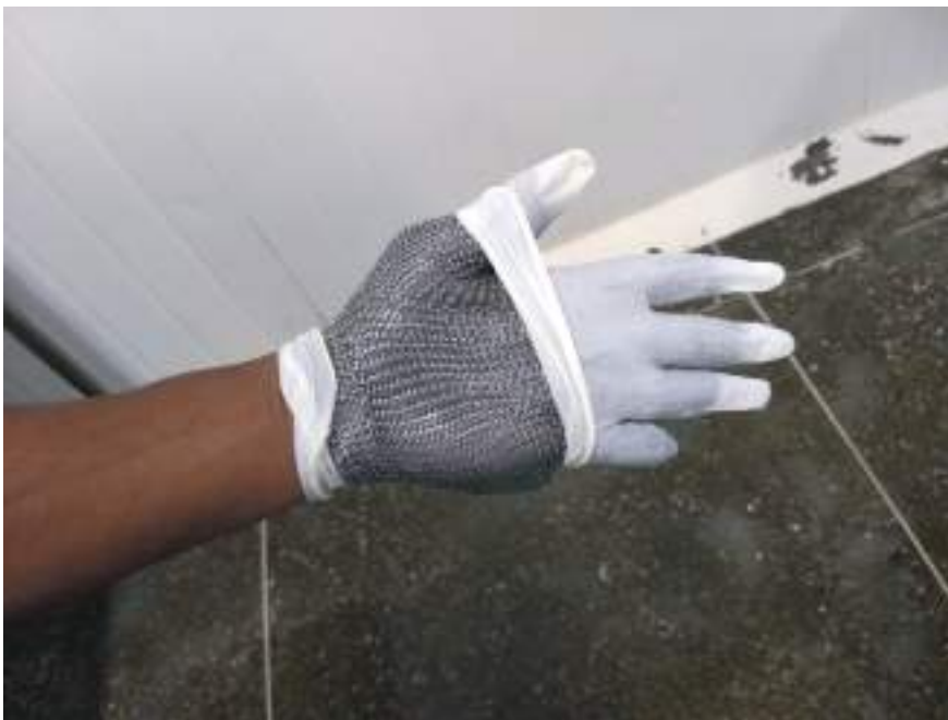
Figura 6. Utilização de luva de malha de aço com a proteção da luva de látex para facilitar a higienização do EPI.
